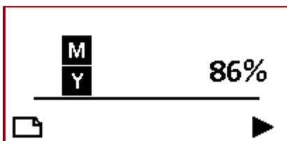
Das Übereinanderdruckfeld und die beiden Grundfarben wurden gemessen. Die Farbannahme (Trapping) wird berechnet und angezeigt. Die Druckreihenfolge wird graphisch angezeigt. In diesem Beispiel wurde Magenta auf Gelb gedruckt.
