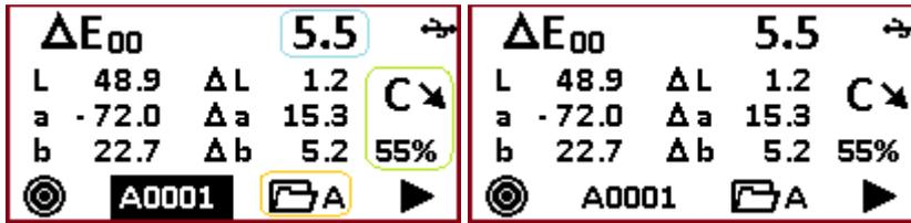
**A0001** Im Auto Modus wird die Referenzfarbe automatisch vom Gerät ausgewählt. Der Name der ausgewählten Farbe wird mit weißen Buchstaben auf schwarzem Hintergrund dargestellt.
